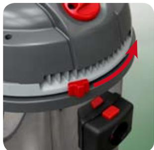
**Système de nettoyage du filtre:** en obturant l'aspiration et en actionnant plusieurs fois le curseur, l'air aspiré est dirigé à l'intérieur du filtre; de cette façon le filtre va se nettoyer et l'aspirateur retrouve un rendement maximal. Une façon rapide et pratique de nettoyer le filtre sans la nécessité d'arrêter ou d'ouvrir l'aspirateur.
